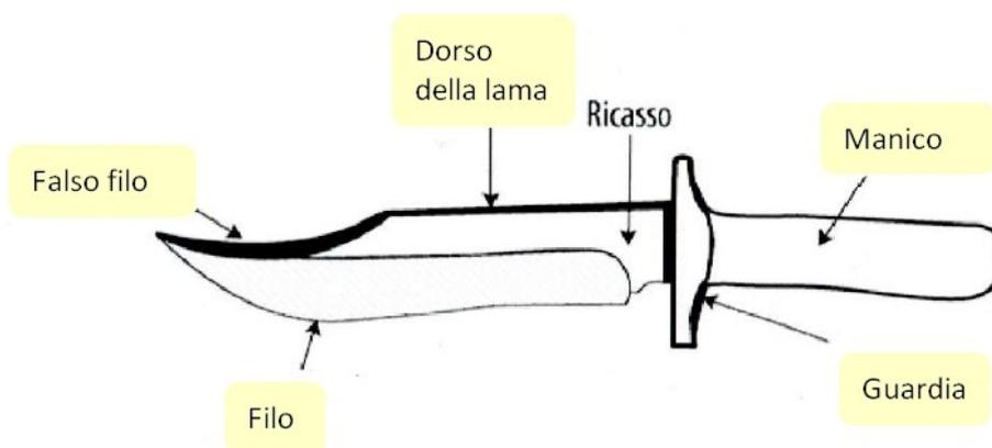
Lo spessore della lama, a livello del filo tagliente e del falso filo, oltre i primi 5 cm dalla punta del coltello, non deve superare i 6 mm, per il resto lo spessore della lama non deve essere maggiore di 8 mm.
